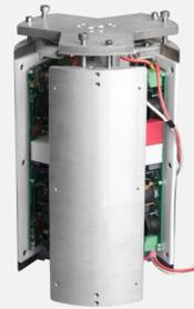
泰思曼 TNP5060 系列是针对远距离输电而设计的恒流电源变换器。其特点是能把恒流电源转换成适合负载使用的低压直流电源。该电源应用多种先进技术，配以完善的保护功能，使其具有高效率，高性能，高可靠性，高冗余，高寿命等特点。已经应用在诸如深海观测网供电等要求高可靠性的领域。
